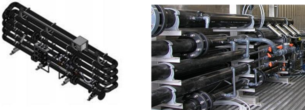
Рисунок 2. Трубчатый флокулятор для коагуляции и флокуляции
